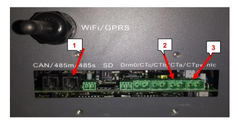
1 → Verificare che il cavo di comunicazione sia stato inserito sulla porta 485 dell'inverter come indicato nella foto sopra, questo cavo andrà poi collegato nella porta RS485 della prima batteria (figura sotto 1).
