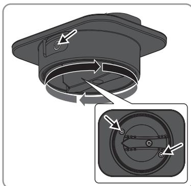
5. Inserire saldamente il sezionatore CC nel dispositivo sull'inverter. Il sezionatore CC deve rimanere in posizione **O** ed essere orientato in maniera che le viti si trovino sopra le filettature.
