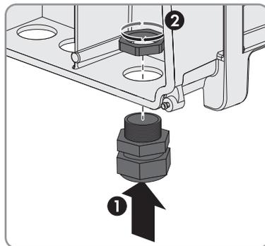
5. Introdurre il cavo CA nell'inverter attraverso il pressacavo. Se necessario, allentare leggermente il dado a risvolto del pressacavo.
