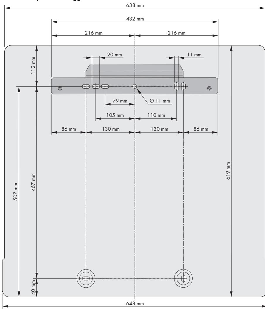
Figura 4: Posizione dei punti di fissaggio
