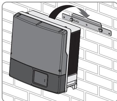
8. Qualora l'inverter sia stato trasportato con una gru, estrarre le viti ad occhiello dalle filettature sulla parte superiore dell'inverter e inserire i tappi ciechi.
