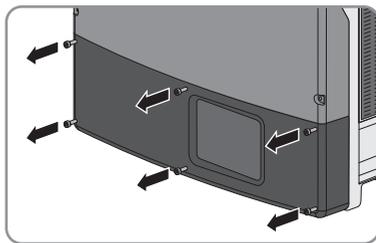
10. Ruotare il coperchio inferiore verso l'alto e rimuoverlo.
