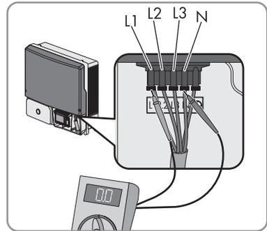
14. Verificare in sequenza l'assenza di tensione sulla morsettiera CA fra **L1** ed **PE**, **L2** ed **PE** ed **L3** ed **PE** con un apposito apparecchio di misurazione. A tale scopo, inserire il sensore nell'apertura rotonda dei morsetti.
