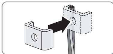
3. Serrare la staffa di fissaggio con la vite a testa cilindrica M6x16 e la rondella M6 (coppia: 6 Nm). I denti della rondella devono essere rivolti verso la staffa.
