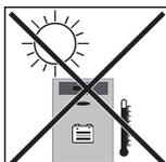
Per ridurre il più possibile il riscaldamento della batteria, non esporla all'irraggiamento solare diretto.
