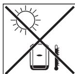
Per ridurre il più possibile il riscaldamento dell'inverter, non esporlo all'irraggiamento solare diretto. Montare l'inverter in una posizione riparata, ad es. nell'area dei moduli solari o sotto una sporgenza del tetto.
