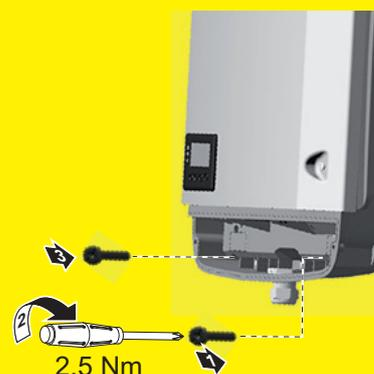
Fissare bene l'inverter al supporto da parete con le viti di fissaggio alla coppia indicata nelle istruzioni per l'uso.
