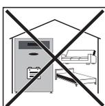
Dato che la batteria in determinate condizioni di funzionamento può emettere una lieve rumorosità, non montarla nelle immediate vicinanze di locali ad uso abitativo.
