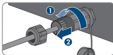
7. Sbloccare il connettore del cavo di rete ed estrarlo dalla presa dell'inverter.
