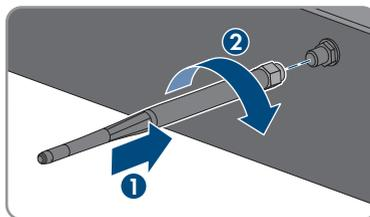
4. Tirare leggermente l'antenna WLAN per accertarsi che l'antenna WLAN sia correttamente in sede.
