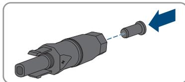
12. Introdurre i terminali CC con i tappi di tenuta nei relativi ingressi CC dell'inverter.
